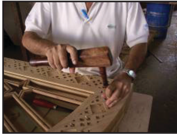
(١): استخدام المدق الخشبي، وهي الأداة الصحيحة.
