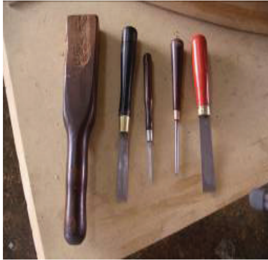
الشكل (١٥٥): الأدوات التي يستخدمها الفنان في الحفر على الخشب، مجموعة أزاميل، ومدق خشبي.
