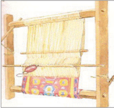
الشكل (١٧٦): نول الكليم ويلاحظ فيه تباعد خيوط السدى بما يتناسب مع التصميم المرسم.
